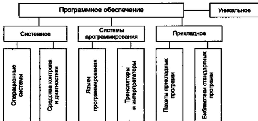
Рис. 4.1. Структура программного обеспечения ПК
