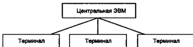
Рис. 3.1. Система централизованной обработки данных
